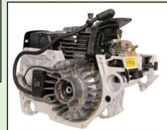
Regime rotazione motore molto elevato (12-14.000 giri/min) → elevate velocità della lama (15-30 m/s). Importante il valore della coppia motrice (Nm) necessaria per vincere la resistenza al taglio
