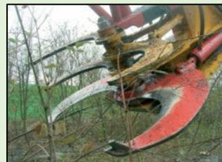
Vantaggi: (i) polloni molto vicini tra loro e non uniformi (max 6); (ii) < richiesta idraulica rispetto a sistema a disco; (iii) massa ridotta; **svantaggi:** (i) lame tendono a spaccare i fusti/ceppaie (no taglio netto)
