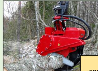
Abbattimento di piante a fusto singolo e omogeneo (fustaie) + accatastamento in fastelli (5-8 fusti) per facilitare operazione di esbosco
