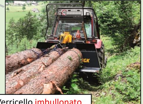
Verricello **imbullonato** al telaio del TR (**pdp** o circuito idraulico)
