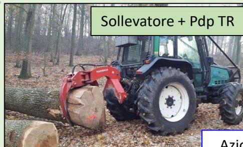
Potenza motore: 100-200 kW; v max: 30 km/h
