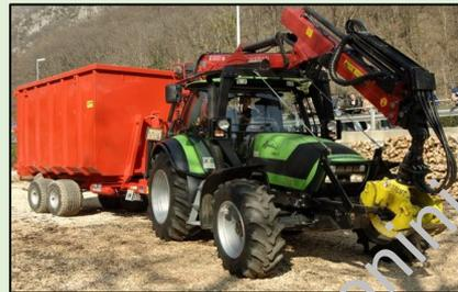
TR a doppia trazione + contenitori acciaio sollevatore idraulico posteriore (massa carico: 1,2 – 2,4 t) e anteriore (0,3-1,2 t)
