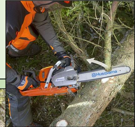
(2) A leva: leva sul fusto per riduzione sforzo; rimozione rami  $d > 3$  cm
