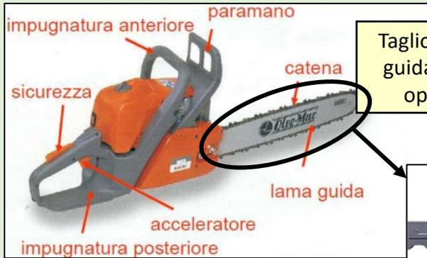
Taglio: catena dentata rotante su una barra di guida; sostegno, controllo e azionamento → operatore (leve di comando e controllo)
